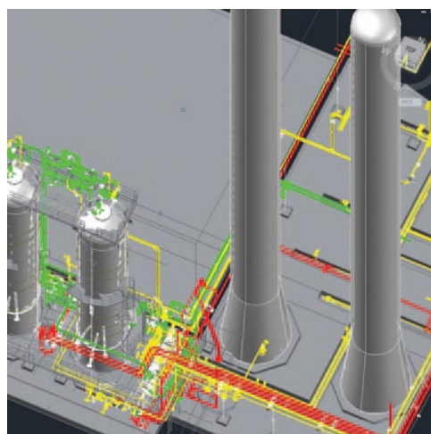
Instalacja ksylenów – reaktory bielenia wraz z orurowaniem. Projekt wykonany w BiproRaf przy wykorzystaniu AutoCAD® Plant 3D
